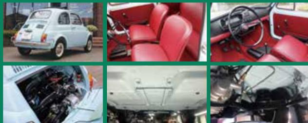
イタリアでフルレストアされおり、シャーシーからボディ、インテリアは新車のように仕上げられています。エンジンは500ccから600ccに変更。ミッションもシンクロ付きに変更して乗りやすく仕上げています。
