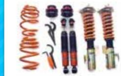
一押しはこちらのKITです。ピロボールマウントによってフロントに最大4°程度までキャンバーが付与できるほか、フロント倒立式の高い剛性、素材を吟味したダンパーの基本性能の高さなど、隙のない構成となっております。パネレート指定可能、さらにレーシングカスタマイズも別途で追加可能となっております。 **¥327,800~**
