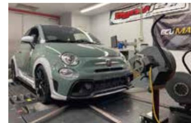
四輪用ダイナモ (負荷装置装着モデル) 4輪駆動対応で前後共1500psまで測定可能。パワーとトルクは、前後単独でも、前後同時でも測定出来ます。4WD車両は、ホイールベース (オプション) が2100mm~3100mmであれば測定可能です。SUV系やスポーツ系等のような4WD車両のトラブルシューティングやチューニングでも対応可能です。チューニング予定のある方、ピフォーア・アフターのパワーチェックも可能です。
