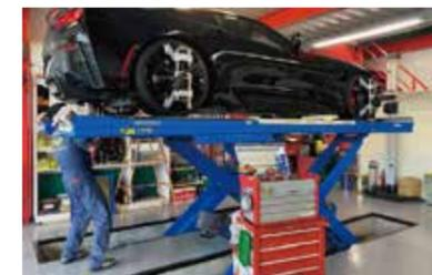
「車がまっすぐ走る」ためにはしっかりとした基礎ができたステアリングやサスペンションのシステムを構成するそれぞれの部品が取り付けられている角度が要求されます。「キャスター角・キャンバー角・キングピン傾角・トーイン&トーアウト」の4つの要素をメーカー規定の基準値や、ローダウンや車高調キットなどカスタム状況に合わせて最適なセッティングに合わせることでタイヤの異常摩耗を防ぎます。
